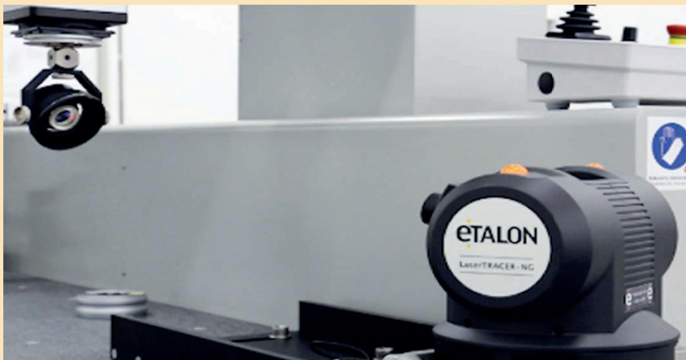
Esta tecnología permite mantener la precisión a nivel interferométrico en todo el proceso de calibración.
