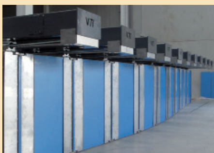
A la izquierda, el Generador de Olas Multidireccional en "snake", y en la imagen de la derecha, Gran Tanque de Oleaje para el Instituto de Hidráulica Ambiental de la Universidad de Cantabria.
