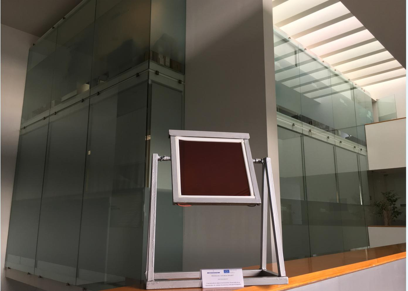
El Instituto Tecnológico de los Materiales ha desarrollado un prototipo de ventana que captura radiación solar y la convierte en electricidad. La tecnología usada se conoce como concentrador solar luminiscente. Se basa en unas pinturas que al depositarlas sobre un vidrio atrapan la luz solar y la reenvían a los extremos del mismo, donde celdas solares convierten esta luz en electricidad.
