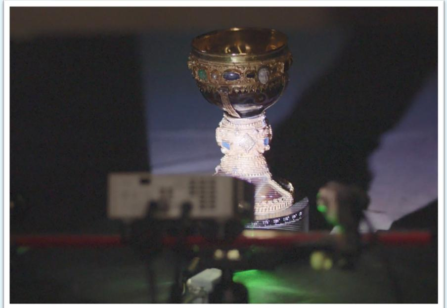
lizó el escáner portátil 3D David de HP, que se basa en la proyección de un haz de luz fotopulsada, un método que no daña la pieza y que permite obtener un modelo exacto en tres dimensiones. Esta avanzada tecnología captura con altísima precisión las dimensiones físicas de cualquier objeto y crea un modelo digital 3D en 360 grados, con una resolución de hasta 0,05 mm. En un entorno de casi total oscuridad se obtuvieron 183 tomas en diferentes alturas y ángulos.
