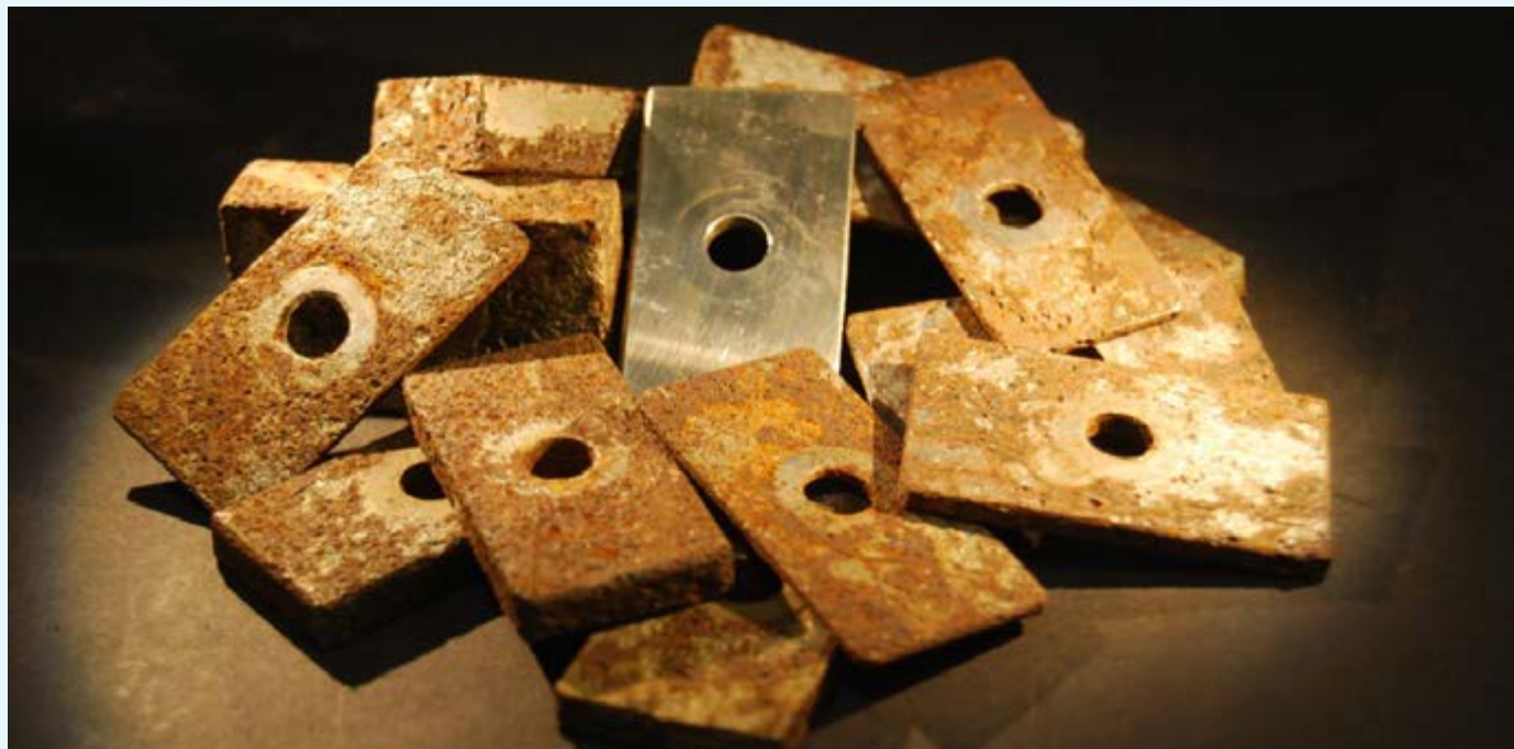
Muestras de acero sometidas a ensayos de corrosión
