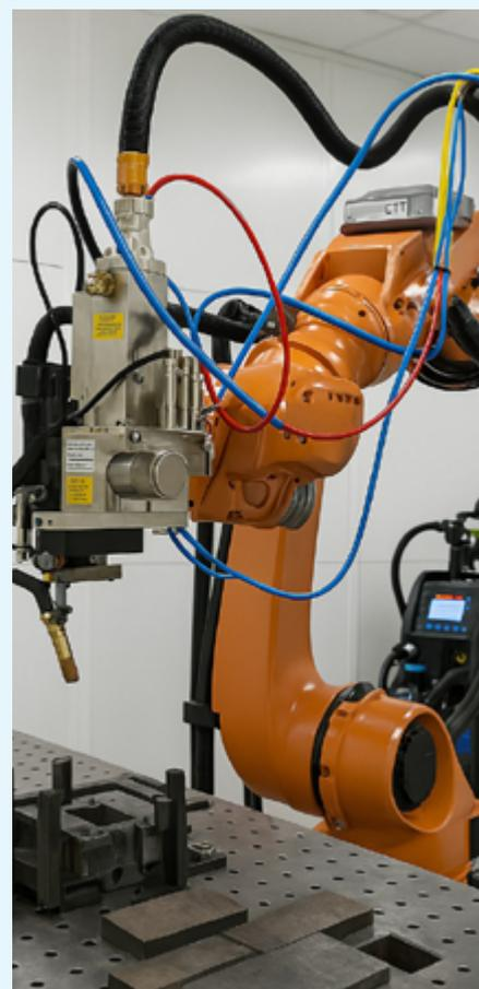
Robot equipado con tecnología de fabricación avanzada WAAM con aporte de hilo
