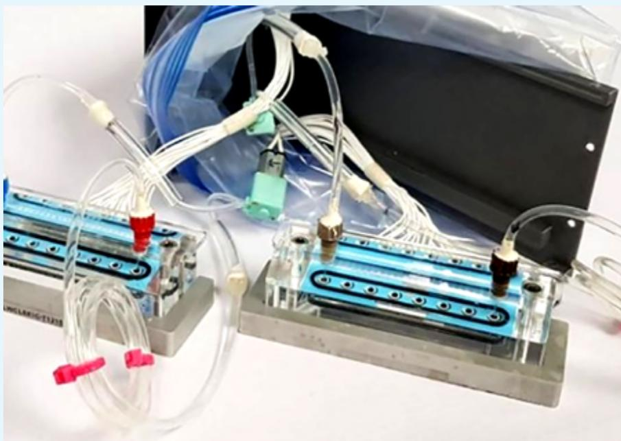
Equipo utilizado para la electro oxidación del amoníaco
