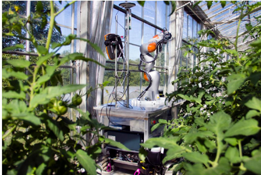
dotarle de habilidades de navegación autónoma. Gracias a este desarrollo, CTC ha sido capaz de dotar al robot de capacidad para navegar por lugares angostos, con un margen de error de tan solo 20 cm en un entorno muy cambiante, condicionado por la presencia de personas y otros obstáculos imprevistos.
