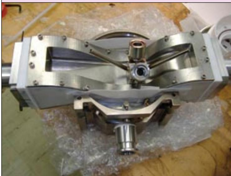
DMA preparado para su instalación en un espectrómetro de masas.
