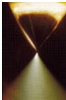
Fuente de ionización basada en electrospray a presión atmosférica
