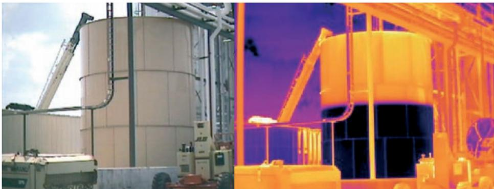
Aplicaciones industriales de la imagen IR. Ejemplo: Control del estado de llenado de tanques
