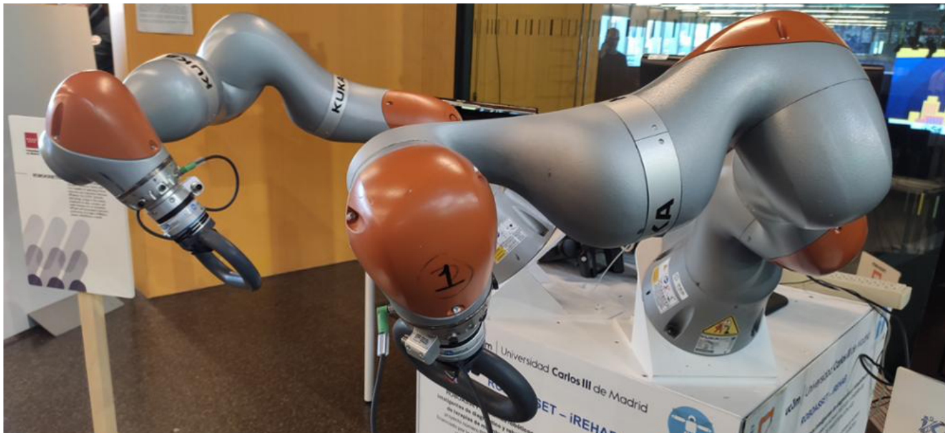
ROBOASSET - iREHAB, el sistema robótico inteligente de diagnóstico y rehabilitación de miembros superiores del Laboratorio de Robótica de la UC3M
