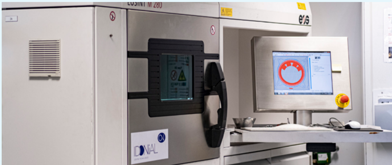
Máquina de fabricación aditiva de titanio usada en el proyecto Chipart
